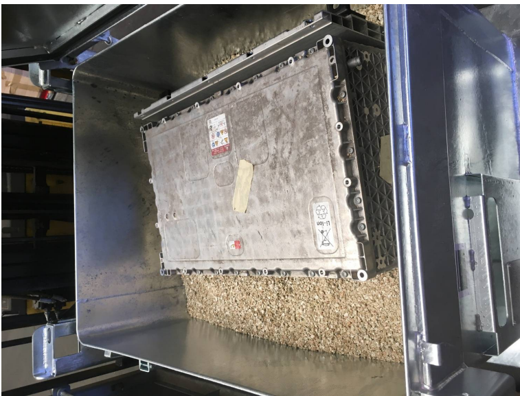
Bovenaanzicht container voor transportgevoelige batterijen
